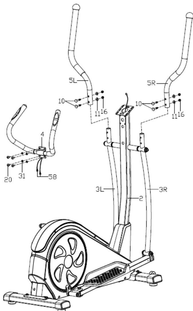
Закрепите верхнюю часть поручня (5L/R) на нижней (3L/R) соответственно с помощью болтов (10), дуговых шайб (11) и нейлоновых гаек (16).
