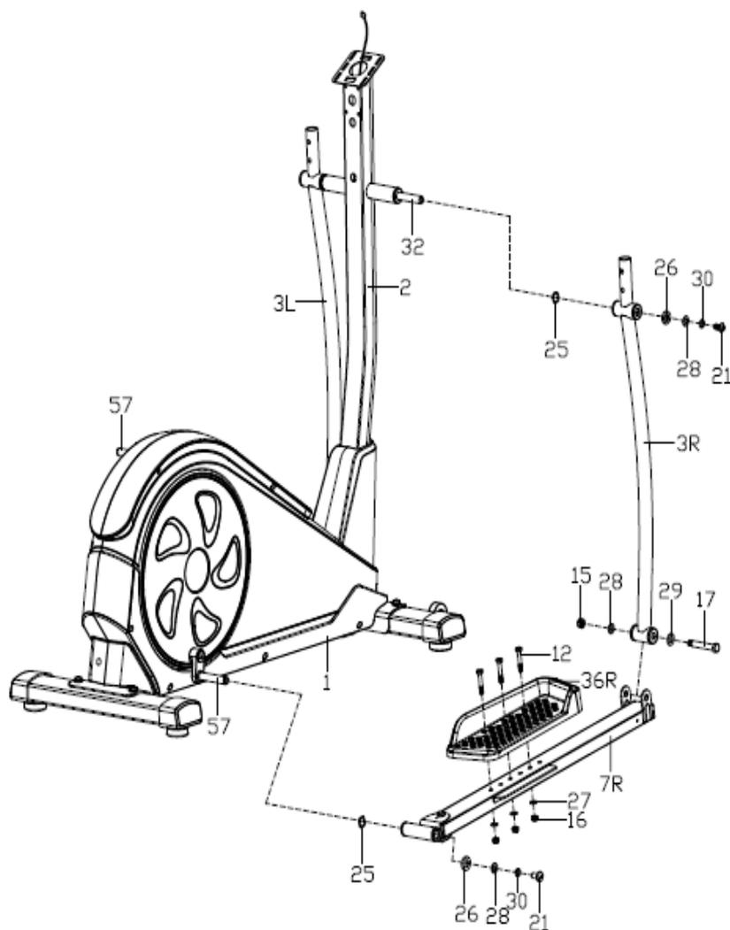
А: Вставьте соединительную пластину для поручней (32) в вертикальную стойку (2), затем установите нижнюю часть поручня (3L/R) на соединительную пластину (32) с помощью шестигранных болтов (21), шайб (30), плоской шайбы (28), D-образных шайб (26) и шайбы (25), как показано на рисунке. На данном этапе не затягивайте детали.
