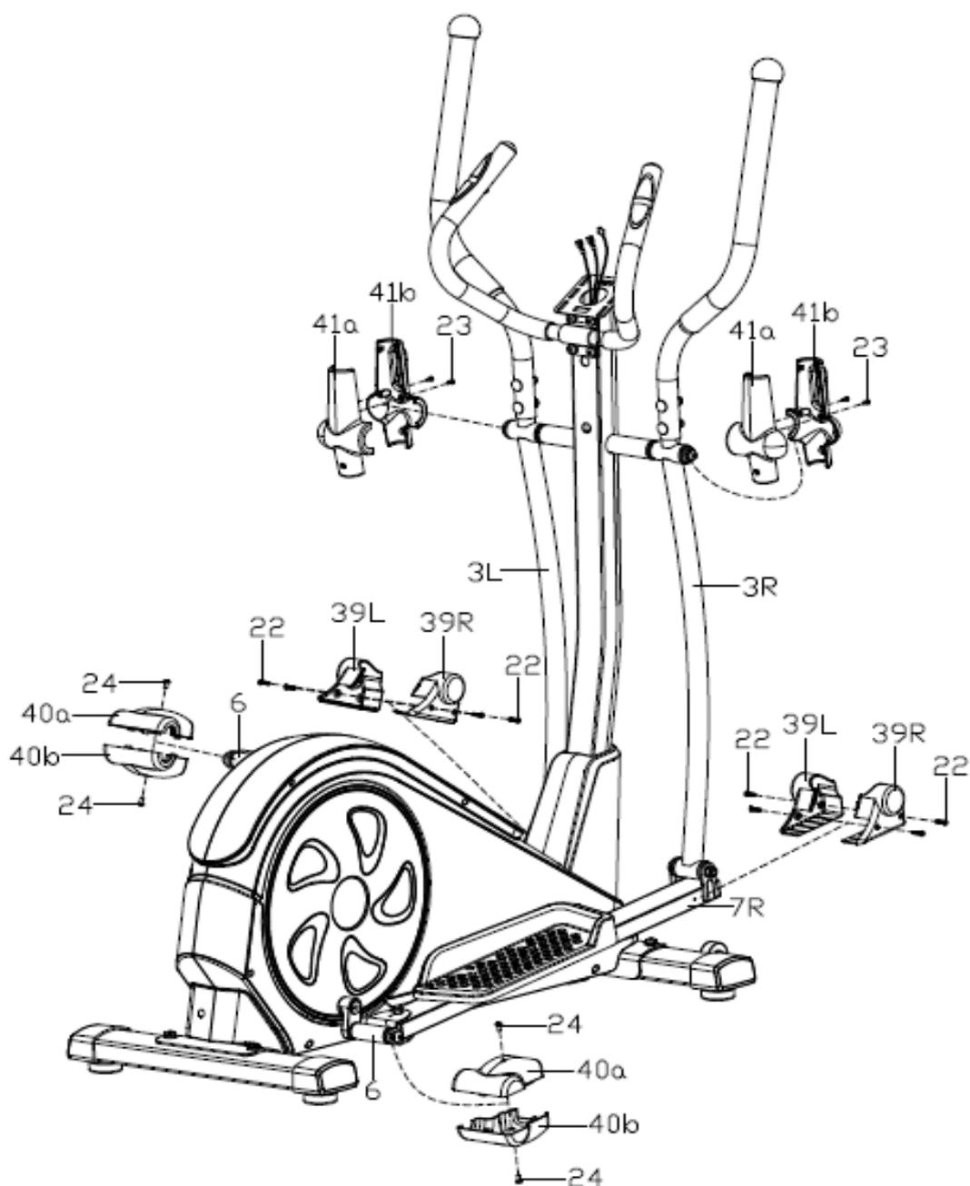
Установите боковые кожухи (41 a/b) на подвижные поручни (3L/R) и закрепите с помощью винтов (23).
