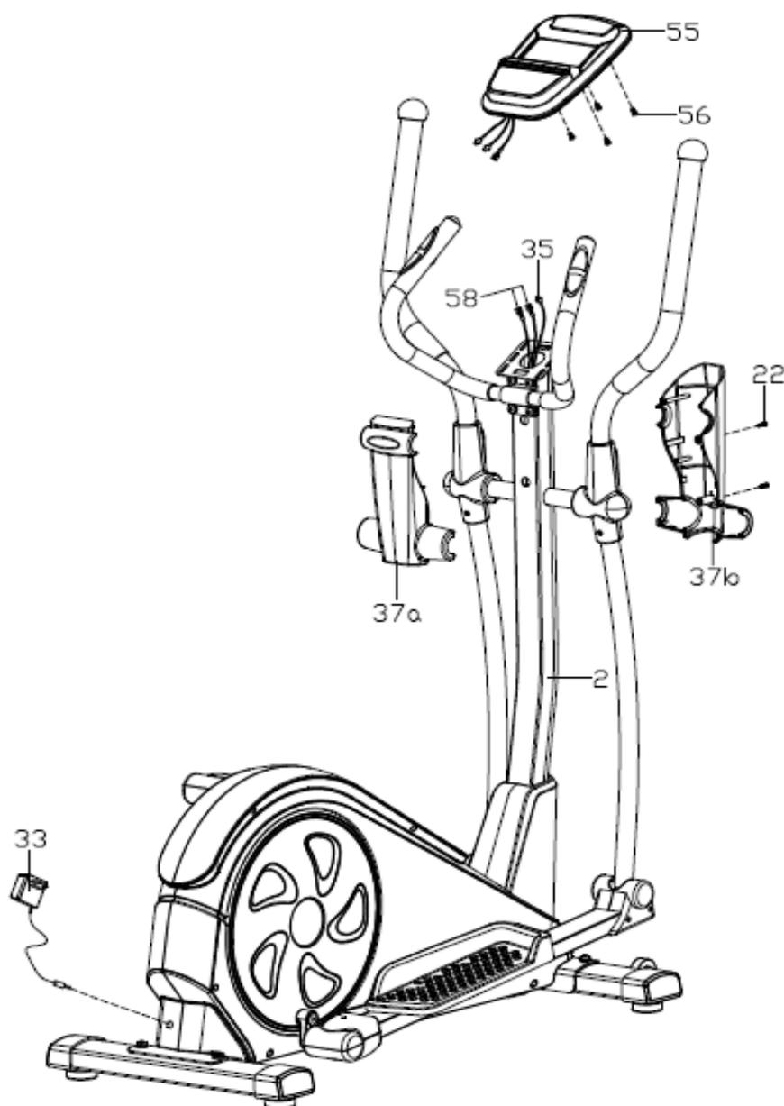
Сначала установите кожух (37а) на вертикальную стойку (2), правильно подсоедините кабель датчиков (35) и кабель датчиков пульса (58) к кабелю консоли (55), затем закрепите консоль (55) на вертикальной стойке (2) с помощью винтов (56).
